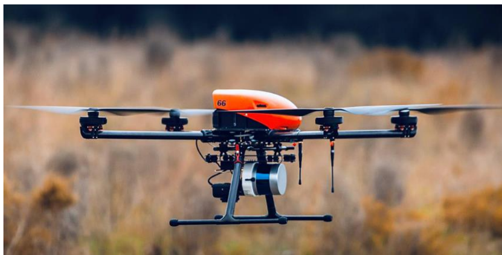
Рис.1. Квадрокоптер «Геоскан 401» с полезной нагрузкой в виде цифровой камеры и воздушного лазерного сканера.
